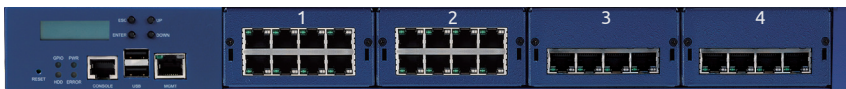
PCIe lane: PCIe x8 PCIe x8 or PCIe x4+PCIe x4 PCIe x4 PCIe x4
